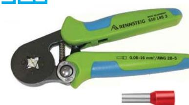
Tipo a regolazione automatica delle ganasce di serraggio. Regolazione manuale della pressione di serraggio. In acciaio speciale, parti operanti temprate e rettificate. Impugnature ergonomiche in materiale bicomponente. Con dispositivo di sbloccaggio in caso di cablaggi difettosi. Per cablaggi a sezione quadra e inserimento frontale del terminale a bussola.
